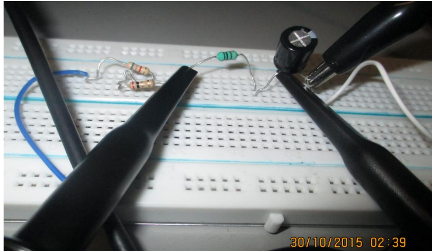
Figura (25).Montaje experimental de un circuito RLC en serie.
