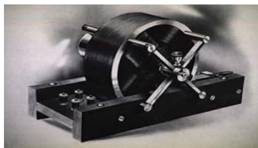
Figura 1. Primer motor de corriente alterna hecho por Tesla. 4
