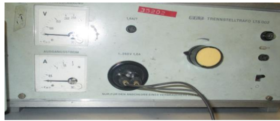
Figura (16) Variak para generar corriente eléctrica alterna.
