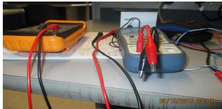
Figura (26) Multímetro y LCR con las cuales se tomaron las medidas.
