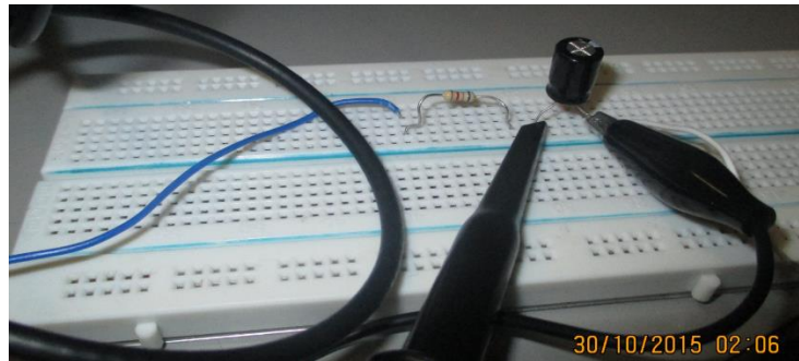
Figura (14).Montaje en el laboratorio de un circuito RC.
