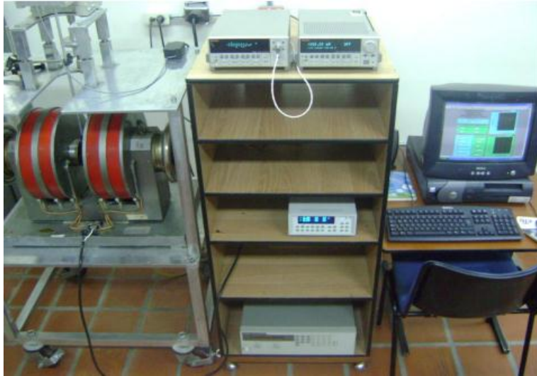
Fig. 18. Sistema de Efecto Hall DC y AC de la UN (Tomado de Melo 2011 pág. 48)
