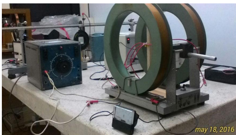
Fig. 17 Toma de datos con un campo magnético suministrado por unas bobinas de Helmholtz.
