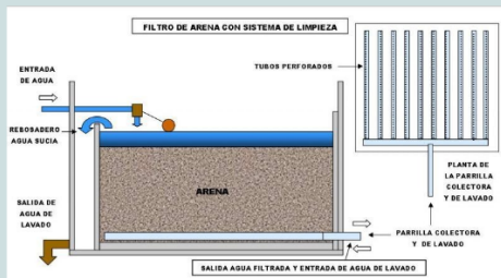
Proceso de Filtración. Fuente Instituto del Agua, 2024.
