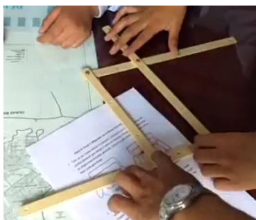
Ilustración 48: Pantógrafo físico configurado al triple de ampliación
