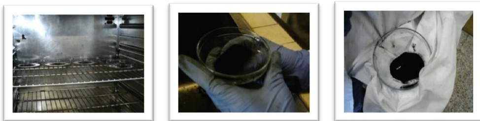
Fotografía 3. Proceso de secado de la magnetita con estufa a 60 °C por 48 horas.
