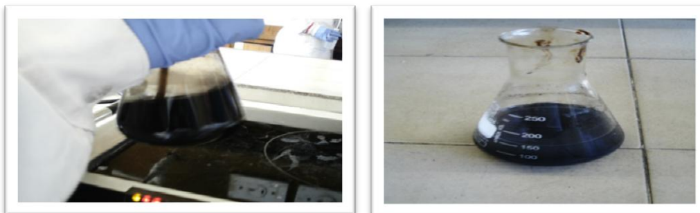
Fotografía 1. Síntesis de nanopartículas magnéticas de hierro por los estudiantes del Énfasis disciplinar I: Sistemas Electroquímicos. Izquierda: proceso de calentamiento y agitación manteniendo la temperatura entre 70 °C y 90 °C sin atmosfera inerte. Derecha: Formación de magnetita posterior a 45 minutos de la mezcla de reactivos
