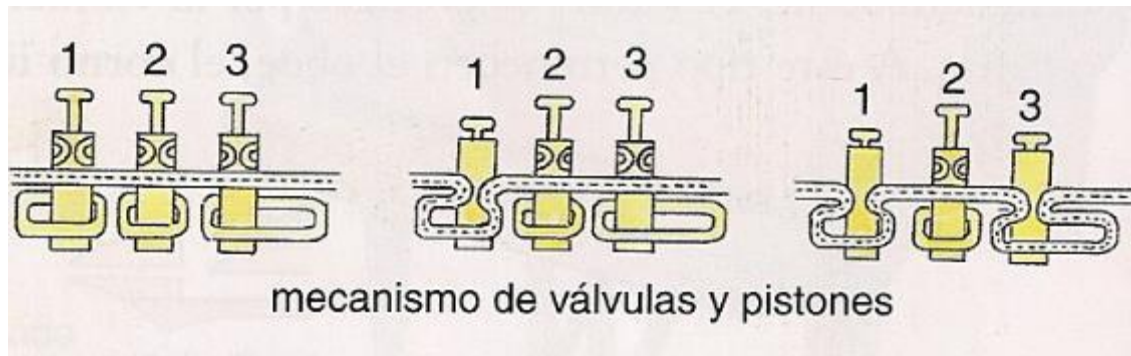
Ilustración 3 Mecanismo de válvulas y pistones. Olga (2009)
