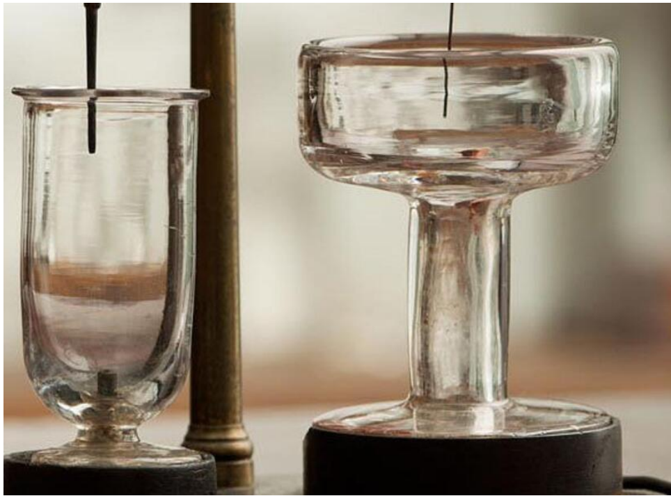
Figura 1A Fotografía del montaje experimental utilizado por Michael Faraday en su motor monopolar. Tomado de Faraday, M (s.f.).
