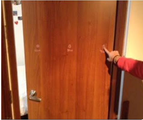
Foto 4 Fuerza a 7cm del eje de rotación
