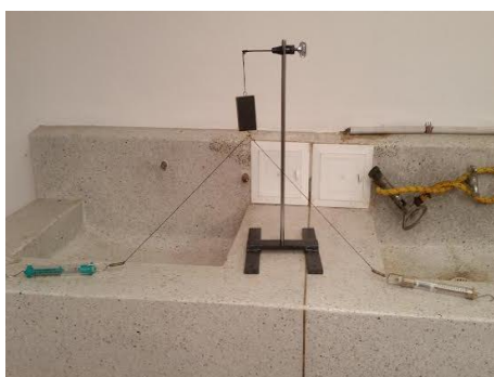
Foto 1 Sistema masa- dinamómetros
