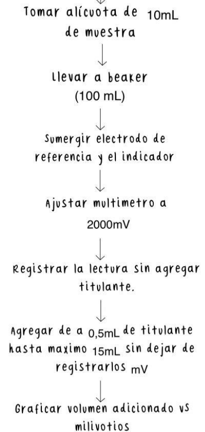
Figura 9. Determinación Cl - escala estándar.
