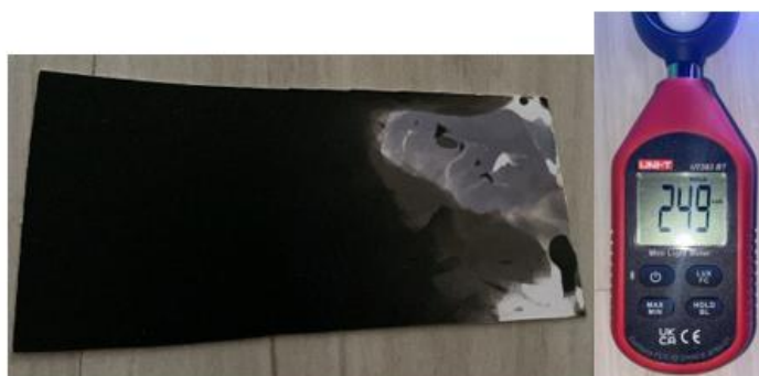
Imagen 8. Papel fotográfico revelado que si tuvo contacto con la luz y valor de intensidad de luz detectado por el luxómetro en este experimento.
