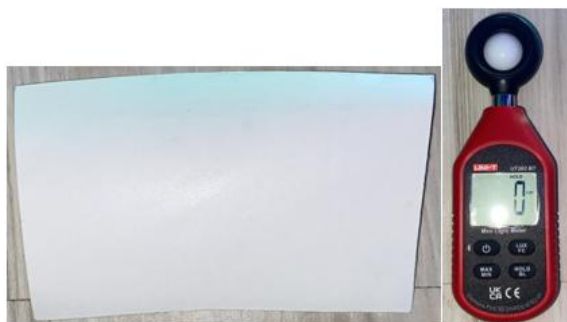
Imagen 7. Papel fotográfico revelado sin contacto con la luz y valor de intensidad de luz detectado por el luxómetro en este experimento.
