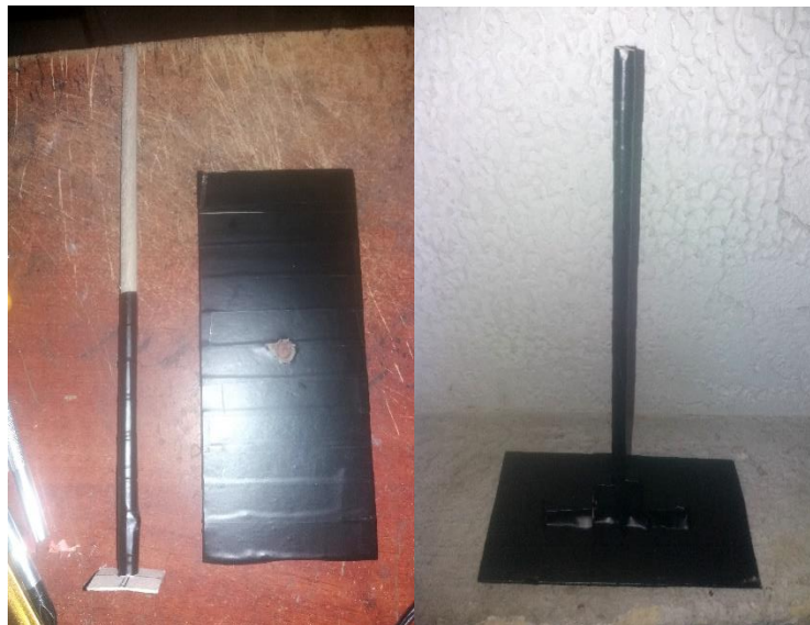
Figura 80 Construcción del Émbolo del Estereoscopio Fuente: propia
