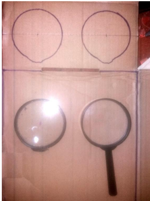
Figura 79 Perforación de los Agujeros para las Lupas Fuente: propia
