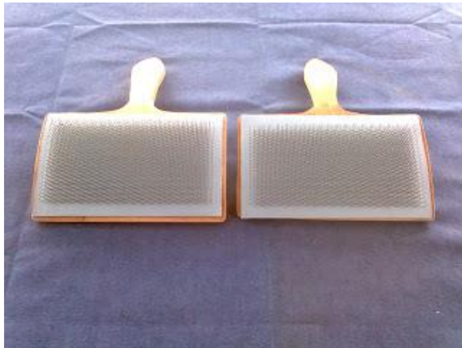
Figura 29 Cepillo para cardar de manera industrial.
