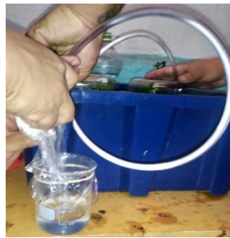
Imagen 14. Organización del experimento, conexión entre el recipiente que contiene la planta y el que produce el dióxido de carbono
