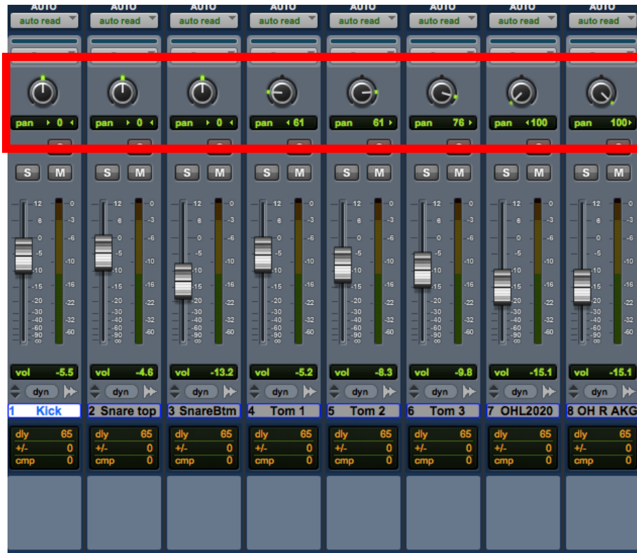
Imagen 74: Estructura de paneo Set de Batería
