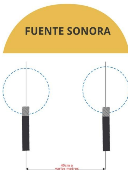
Imagen 33: Técnica estereó AB. Fuente: http://blog.7notasestudio.com/tecnicas-de-microfonia-estereo/
