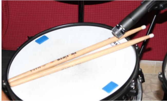
Imagen 35: Posicionamiento micrófono Redoblante
