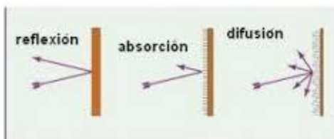
Imagen 7: Efecto de los materiales acústicos. Fuente: http://www.mundodvd.com/acondicionamiento-acustico-2658/
