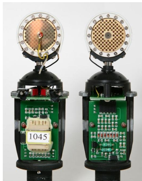
Imagen 26: Vista interna de micrófono de condensador.
