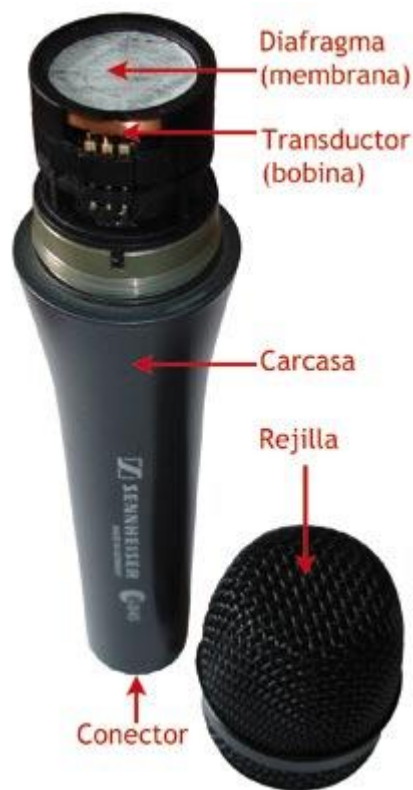
Imagen 25: Partes de un micrófono dinámico. Fuente: http://www.analfatecnicos.net/pregunta.php?id=34
