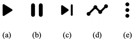
Ilustración 17. Iconos menú del superior de SFFS Line Graphs. a) Inicio de la reproducción y SFFS Equalizer. b) Pausa de la reproducción. c) Cambio de canción. d) Activación de plano para las gráficas e) Selección de sensores a graficar
