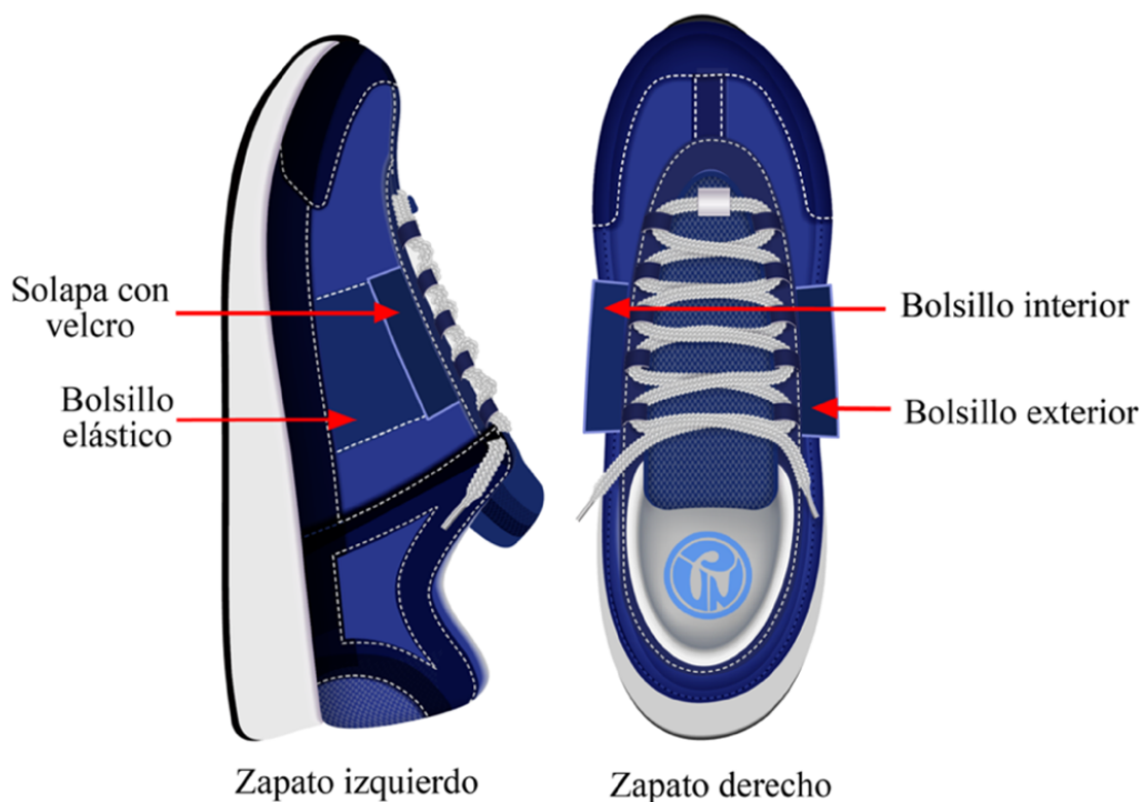
Ilustración 9. Vista lateral y superior de los zapatos diseñados para SFFS con señalización de los bolsillos exterior e interior y la solapa con velcro que cierra el bolsillo.
