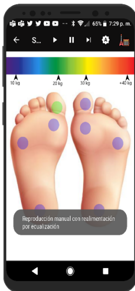
Ilustración 28. Imagen de realimentación entregada al usuario en la APP al hacer una posición donde solo se ejerce presión en el sensor 1 del pie izquierdo.
