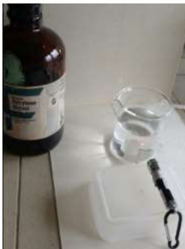
Figura 27. Montaje experimental para determinar el índice de refracción
