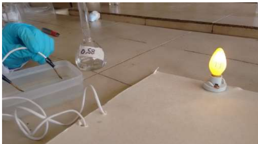
Figura 21. Montaje empleado para la validación experimental de la actividad 2. Medición cualitativa de conductividad
