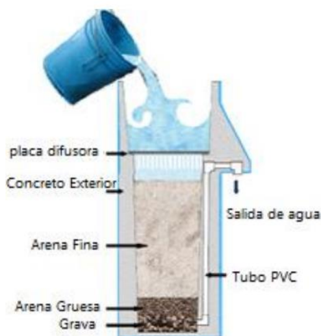
Figura 1. Sistema de filtración del agua
