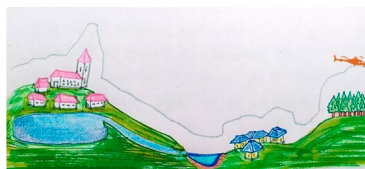
Figura 18. Funcionamiento de un microscopio de campo cercano. Helicóptero sobrevolando un terreno de manera análoga a como la punta de un microscopio de campo cercano recorre una superficie definiendo su topografía
