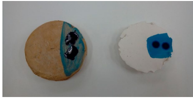
Figura 68. Adición de gotas de azul de metileno en superficie pintada
