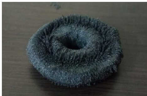
Ilustración 10. Imán de ferrita con viruta de hierro.
