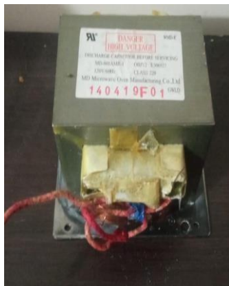
Ilustración 22. Transformador de microondas de 2500V a 0.6 a.
