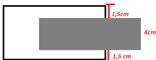
Ilustración 5. Imagen correspondiente al montaje del condensador de placas paralelas.
