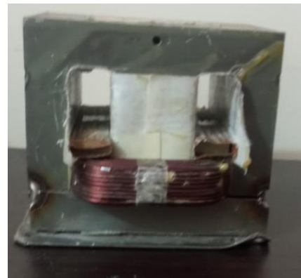
Ilustración 11. Transformador de microondas modificado.
