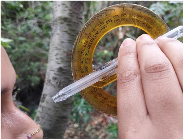
Anexo 3: Toma de medida de la pendiente de la huerta de la Microcuenca de la Quebrada Tibanica con un Clinómetro casero, fotografía Silva M, 2023.
