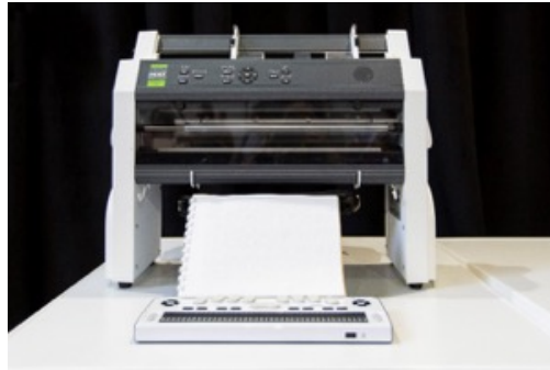
Ilustración 9: Impresora braille con hojas impresas y un teclado al frente
