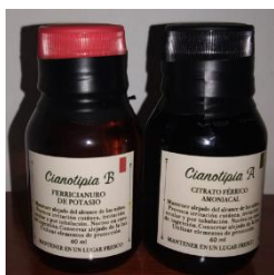
Figura 15. Químicos necesarios para la cianotipia. Químico A (citrato férrico amoniacal) y Químico B (ferricianuro de potasio). Elaboración propia.
