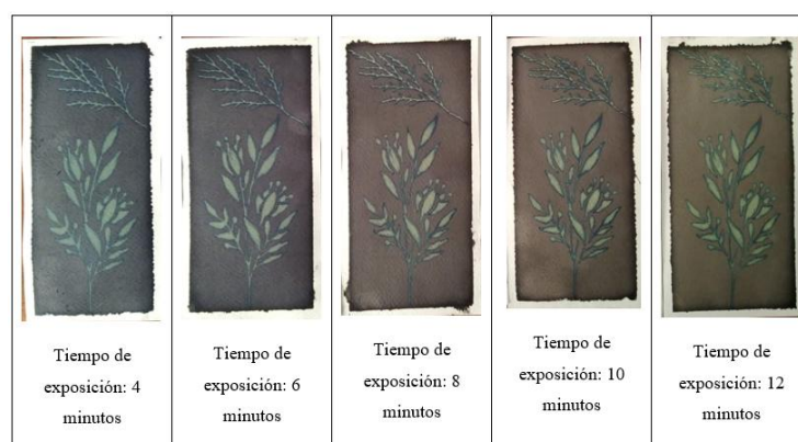
Figura 18.Registro temporal de papel sensibilizado con cianotipia. Cada papel se expuso a la luz solar natural en intervalos de 4, 6, 8, 10 y 12 minutos. Elaboración propia.
