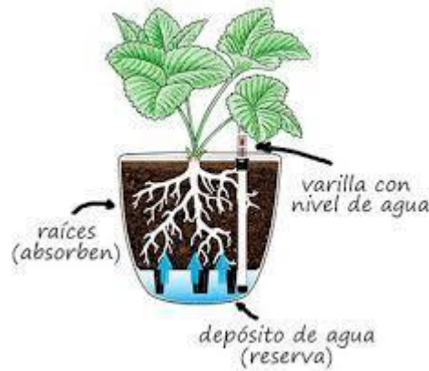
Figura 19. Hidrojardinera. Imagen tomada de: https://macetasautorriego.com/
