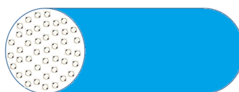
Figura 1-5. modelo de corrientes de ampere, donde hay una magnetización neta a lo largo del eje del cilindro.
