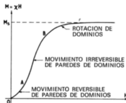
Figura 1-12. Magnetización de un material ferromagnético.
