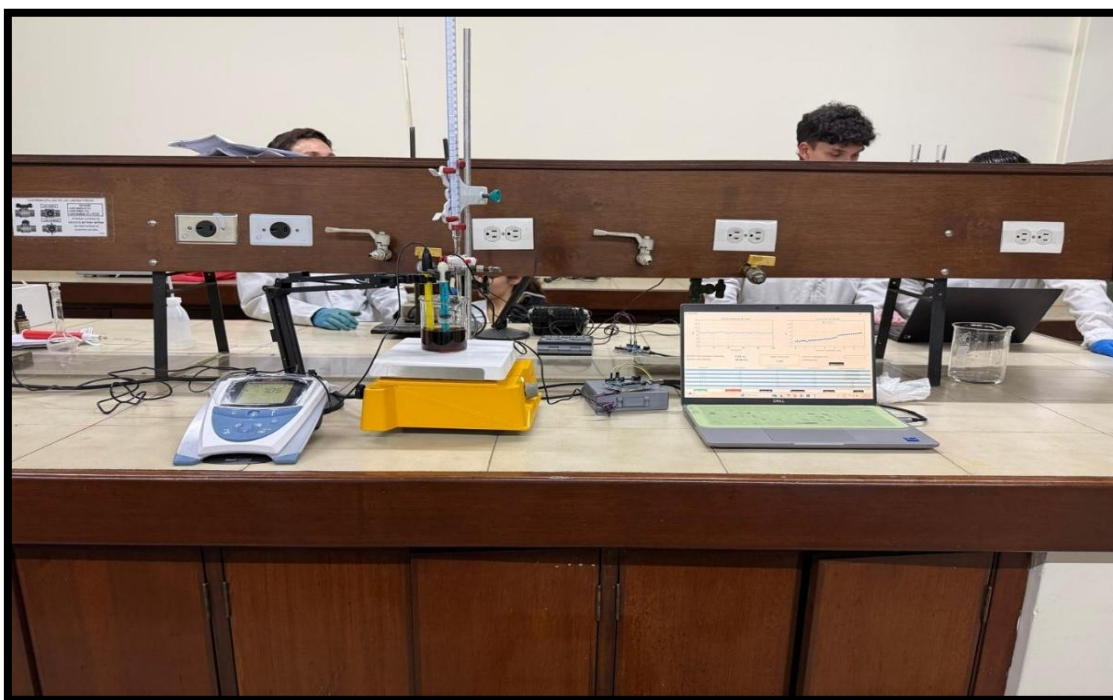
Figura 41. Software TitrCurve en paralelo con el potenciómetro de referencia.
