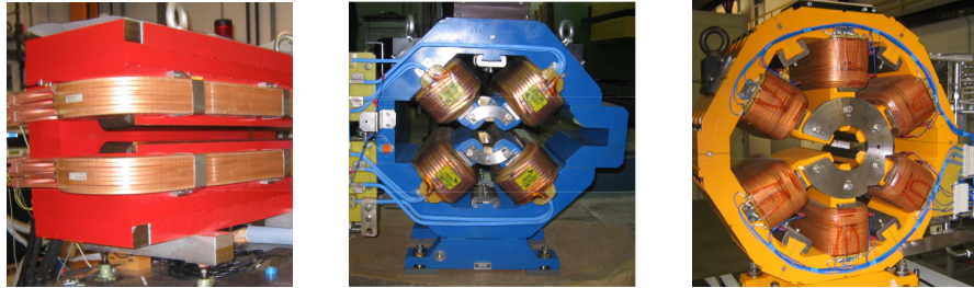
Figura 3-5: Electroimanes reales utilizados en la línea de transporte de un acelerador circular.
