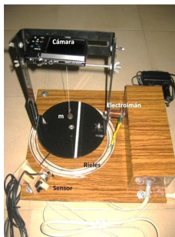
Figura 1. Imagen del dispositivo de movimiento circular para el estudio de la fuerza de Coriolis.
