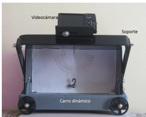
Figura 1. Imagen del carro dinámico con un péndulo al interior y una videocámara.
