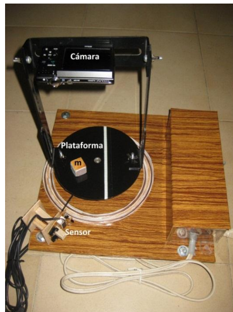
Figura 3.7. Imagen del arreglo experimental para la visualización y estudio de la fuerza centrífuga.
