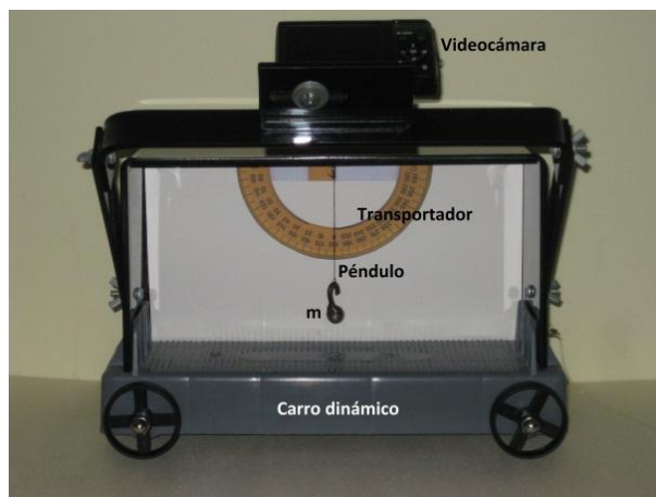
Figura 3.2. Imagen del carro dinámico el cual, sirve para la comprensión de los marcos de referencia inercial y no inercial, y la fuerza ficticia en un movimiento rectilíneo uniformemente acelerado.
