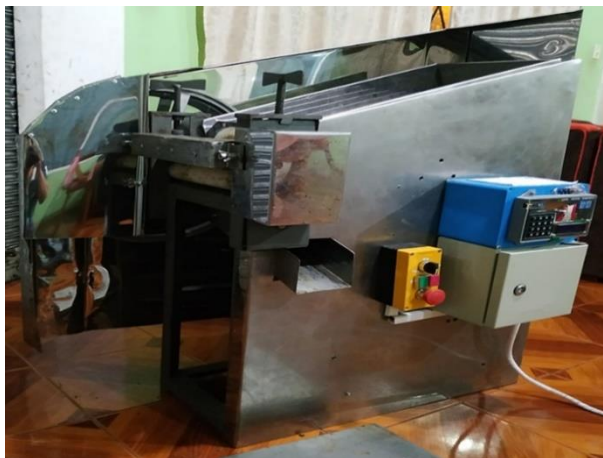
Imagen 10. Máquina semiautomática desgranadora y dosificadora de arveja para el sector artesanal
