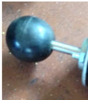
Reuda se inserta en el tornillo del motor
