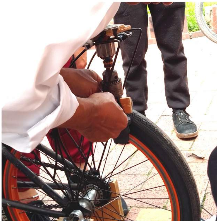
Recubriendo el rotor con caucho para evitar que dañe la llanta.
