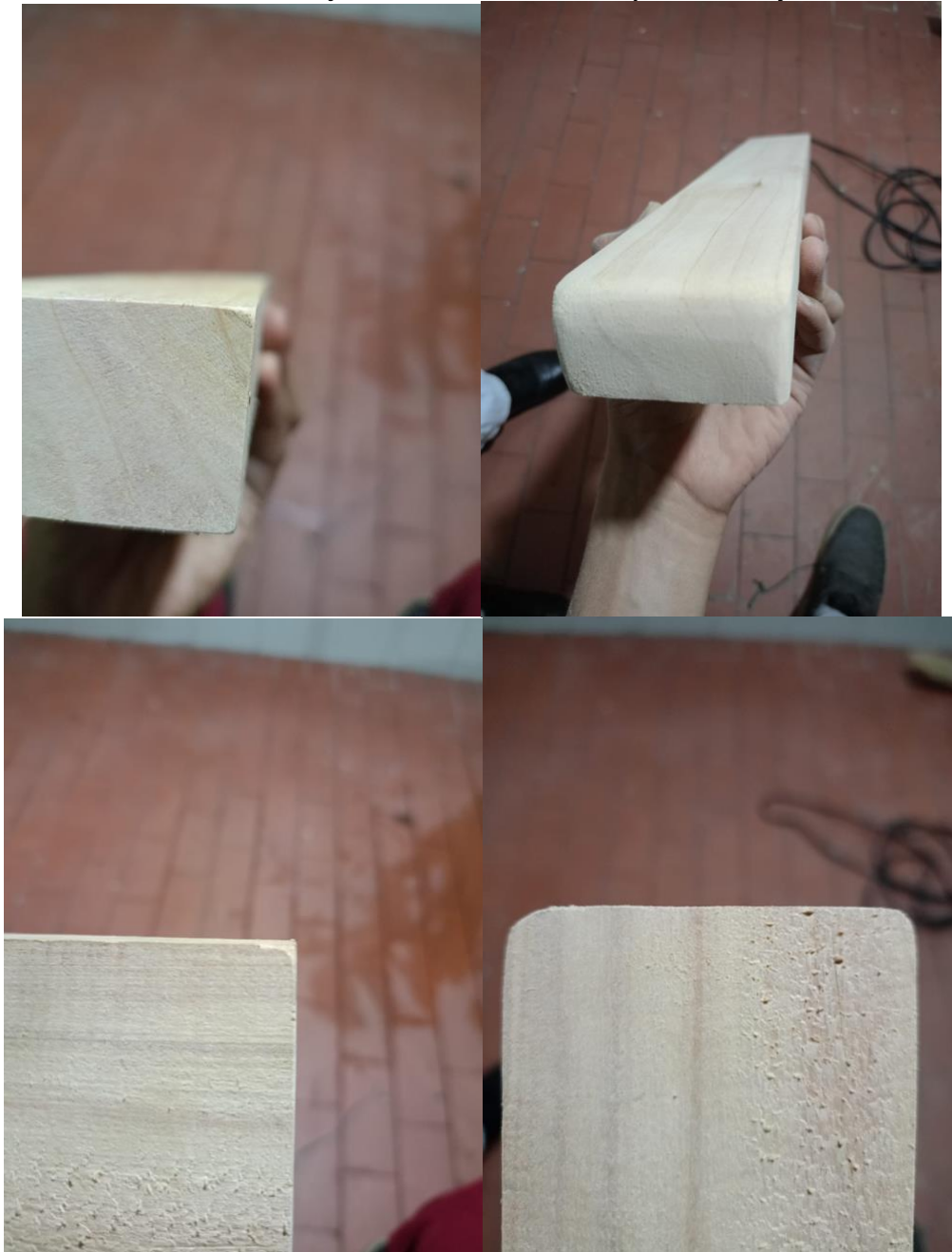
Placa B2 antes de ser lijada a mano. Placa B2 después de ser lijada a mano
