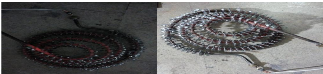
Figura 43: Resistencia calefactora en espiral con aleteado en aluminio (calefactor 2). Fuente propia
