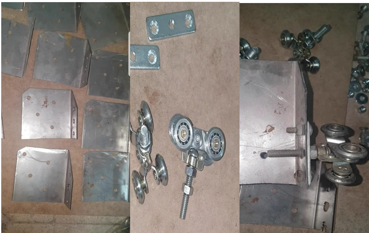
Figura 23: Pletinas de sujeción y rodachinas tipo carrito. Fuente propia
