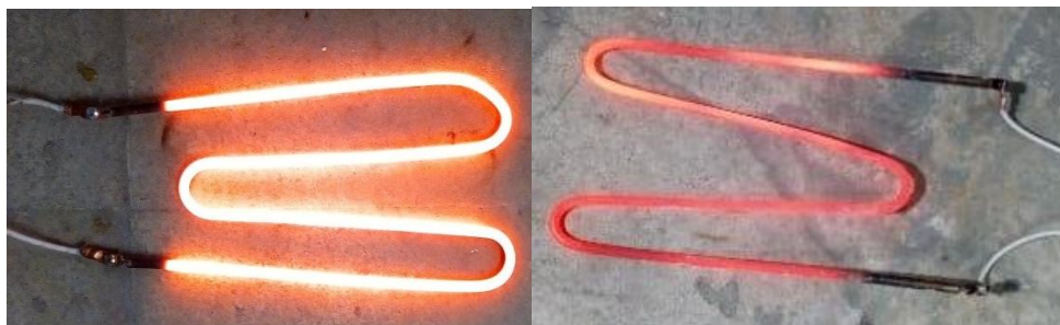
Figura 40: Resistencias calefactor 1. Fuente propia
