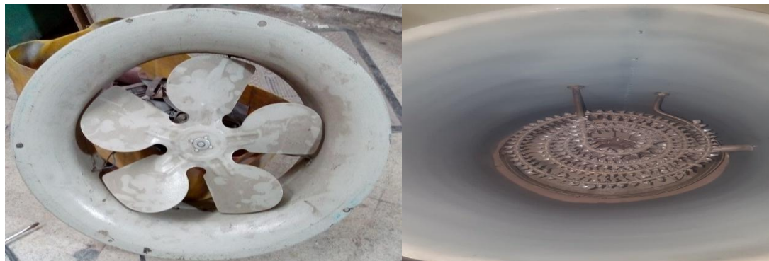
Figura 44: Turbina y resistencias (calefactor 2). Fuente propia
