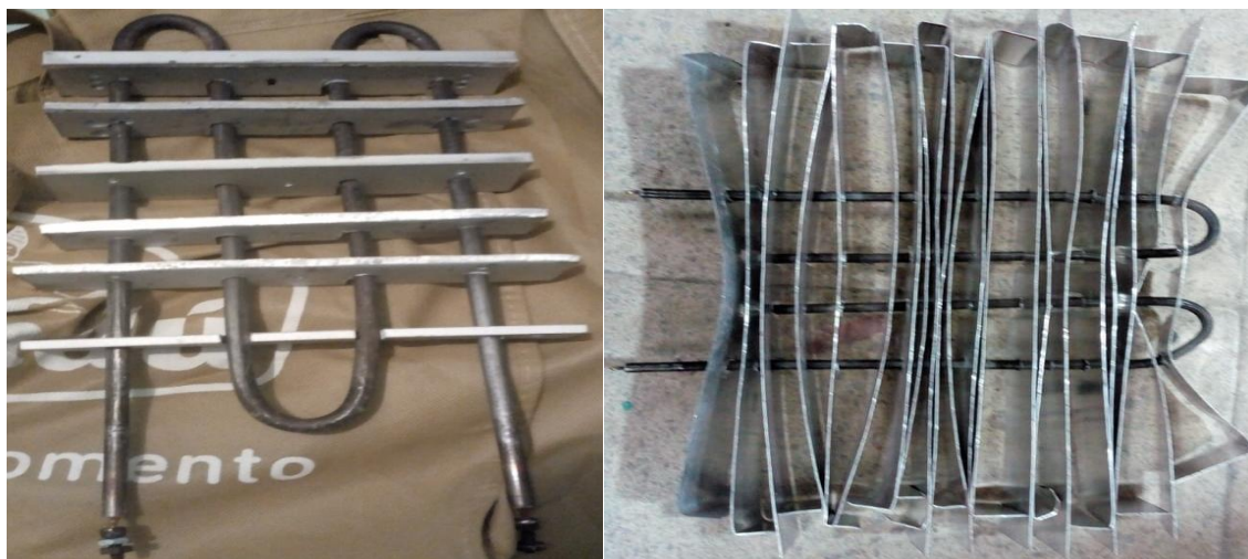
Figura 41: Resistencias con aleteado en aluminio para disipación de calor (calefactor 1). Fuente propia
