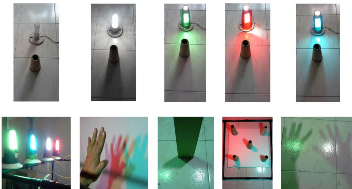
Figura 6. Montaje para trabajar sombras y colores. Compuesto de papel celofán y bombillos ahorradores.
