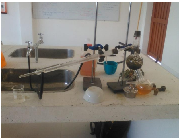
Ilustración 31: Proceso de destilación de aceites esenciales. Fotografía tomada por: Camilo Rico.
