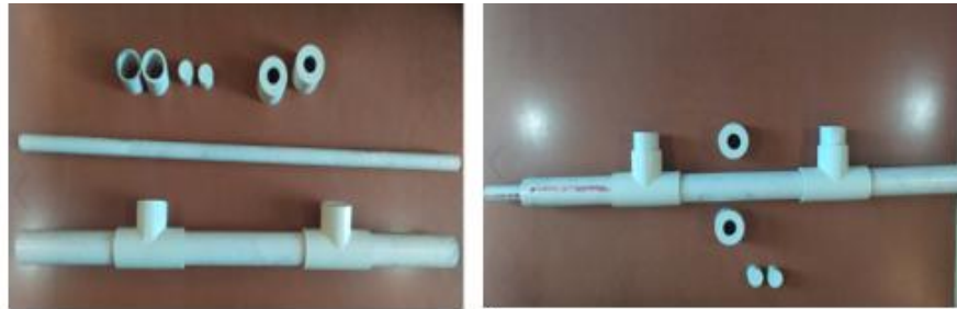
Ilustración 19. Foto unión del tubo externo y colocación del tubo interno.
