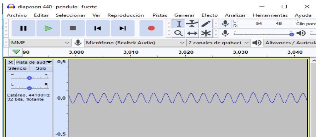
Ilustración 7. Diapasón de frecuencia de 440 el cual se golpeó fuerte
