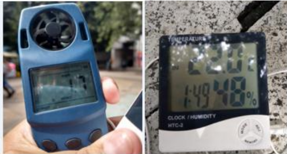
Imagen 20. Anemómetro e higrómetro utilizado en la actividad. Fuente propia
