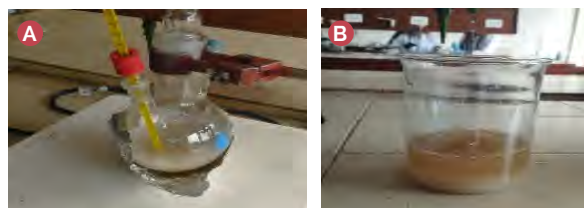
Figura 4. Resultados de extracción de colágeno hidrolizado del WW con hidrólisis básica
