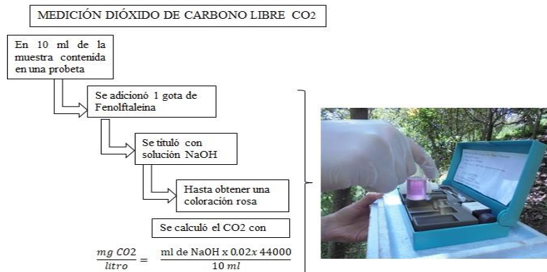
Diagrama 5: Método empleado para determinar Dióxido de Carbono CO 2 por titulometria. Fuente: APHA, 1992 Fotografía tomada por: Gonzalez,S. (2017)
