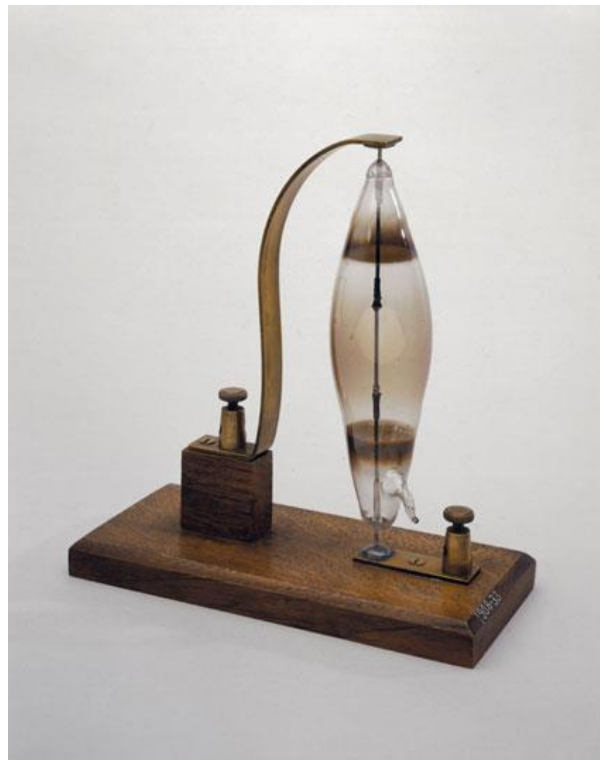
Ilustración 04: Lámpara incandescente de filamento de carbono diseñada por Swan (Imagen tomada del sitio web http://www.sciencemuseum.org.uk/ )
