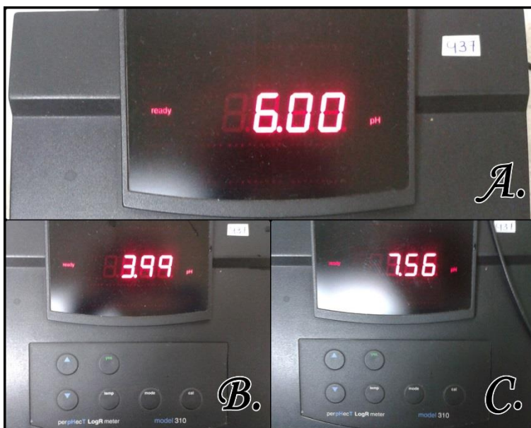
Imagen 5.11. Potenciómetro con los 3 pH utilizados para el estudio de producción de enzima celulolítica.
