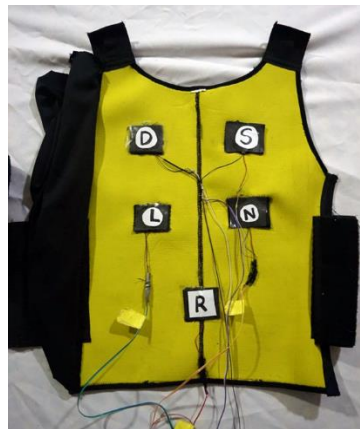
Ilustración 5 Ubicación de los motores representando los fonemas consonánticos
