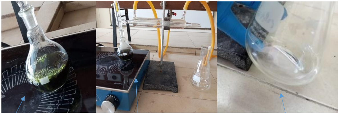
Proceso de destilación por arrastre de vapor de la hoja de la albahaca. Elaboración propia
