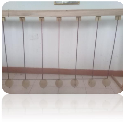
Imagen 13: montaje experimental de osciladores acoplados
