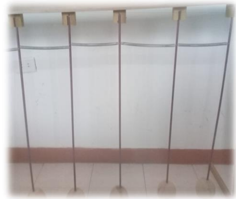
Imagen 15: montaje experimental de más de dos osciladores acoplados
