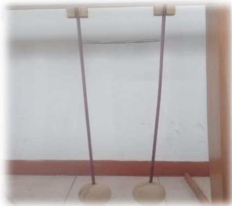
Imagen 14: montaje experimental de dos osciladores acoplados
