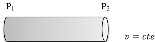
Figura 8: En un elemento de volumen con diferencia de presión, pero velocidad constante.
