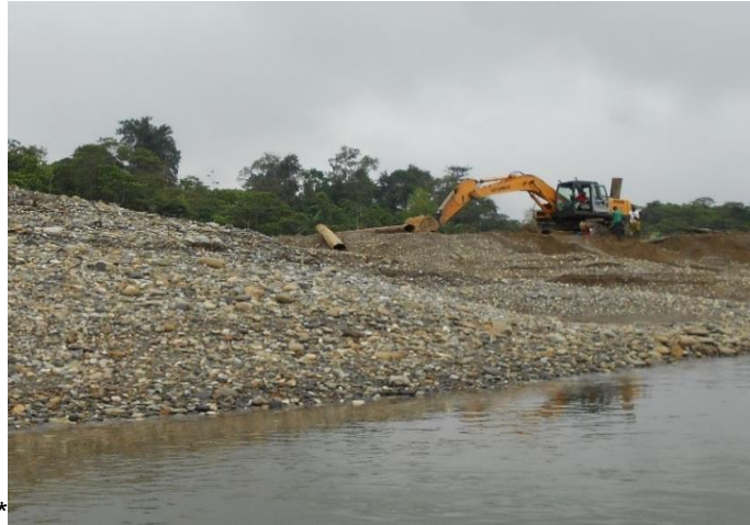
Imagen 30. Retroexcavadora, socavando para encontrar oro y sacar gravilla a orillas del río Magüi. Fotografía tomada por: Orjuela, 2019.
