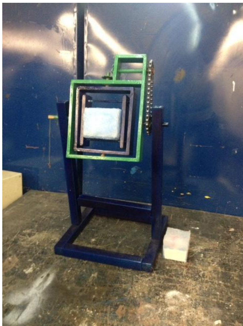
Figura 40.EVIDENCIAS, ROTOMOLDEADORA TERMINADA CON MOLDES.
