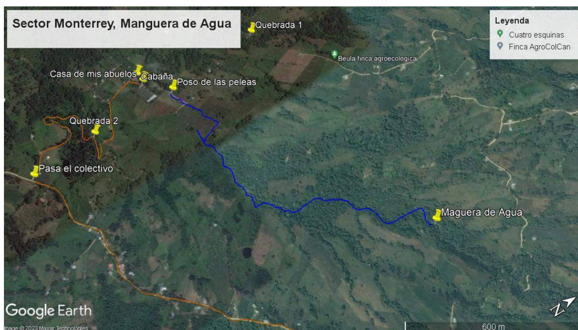
Figura 9 Recorrido de la manguera principal de la bocatoma a el pozo de reserva en Monterrey, Fuente: Google Earth, 2024.
