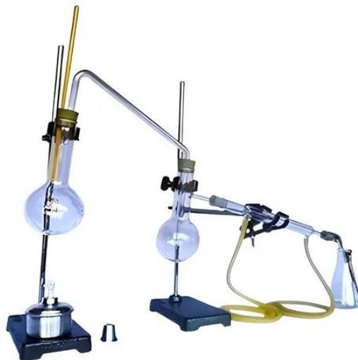
Montaje de extracción destilación por arrastre vapor
