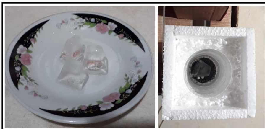
Imagen 9: cubitos de hielo de igual tamaño dentro del baso plástico del calorímetro Tomada de: Imagen propia.
