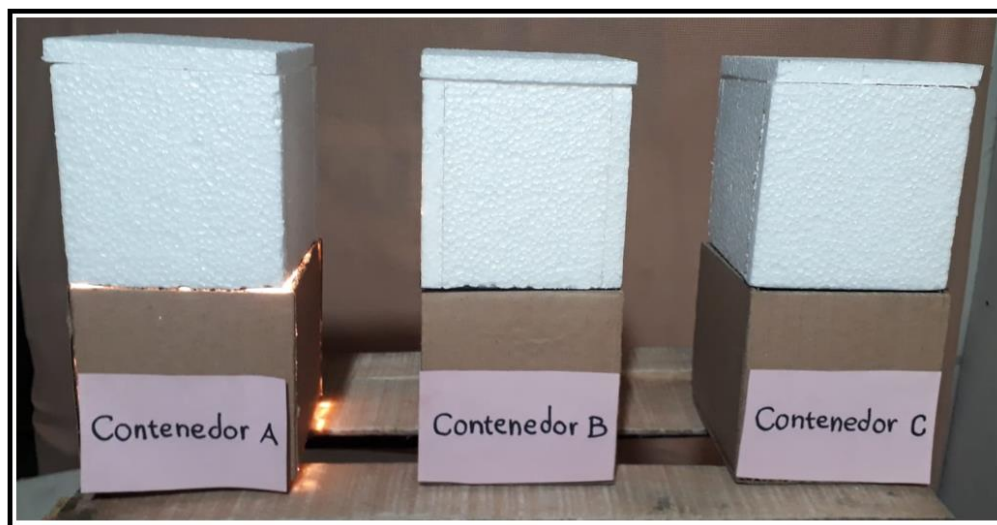
Imagen 10: Contenedor A, B y C con los calorímetros cerrados. Tomada de: Imagen propia.
