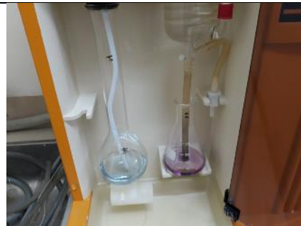
Imagen No. 2: Destilación Kjeldahl
