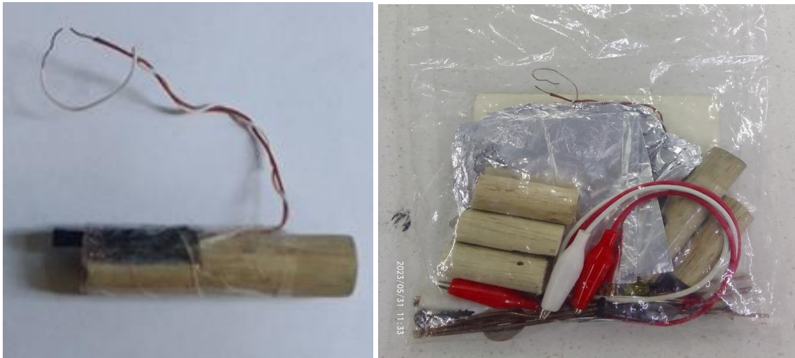
imagen 8. A la izquierda Chispometro casero, a la derecha kit de montaje A1 Y B1
