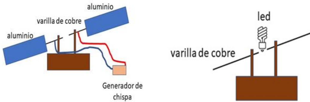
imagen 9. A la izquierda montaje A1 (emisora), a la derecha Montaje B1 (receptor)
